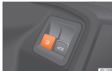
Afb. 203 Bestuurdersportier: ontgrendeling van de tankklep.
