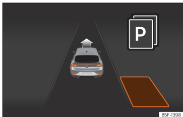
Afb. 151 Op het display van het instrumentenpaneel: beperkte weergave van het inparkeersysteem.
