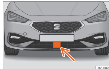
Afb. 123 In de voorbumper: radarsensor.
