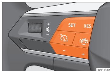
Afb. 130 Op het multifunctiestuurwiel: knoppen voor bediening van de snelheidsbegrenzer.
