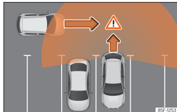
Afb. 157 Schematische voorstelling van de uitparkeerhulp: bewaakt gebied rond de wagen die een parkeerplaats verlaat
