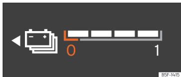
Afb. 8 Digitaal instrumentenpaneel: accupeilmeter.
