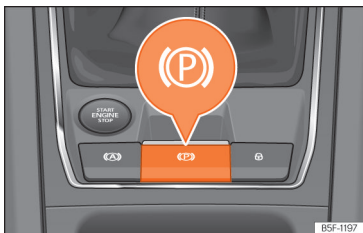
Afb. 147 Onder in de middenconsole: toets van de elektronische parkeerrem.
