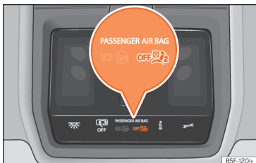
Afb. 33 In de dakconsole: controlelampje van uitschakeling bijrijdersairbag.
