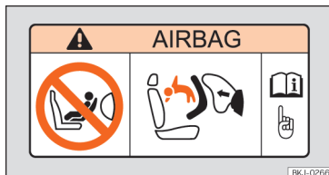
Afb. 42 Airbagsticker: op de zonneklep aan bijrijderszijde.
