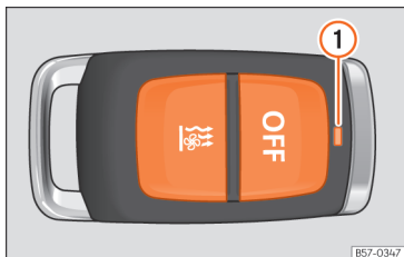
Afb. 114 Interieurvoorverwarming: radiografische afstandsbediening.
